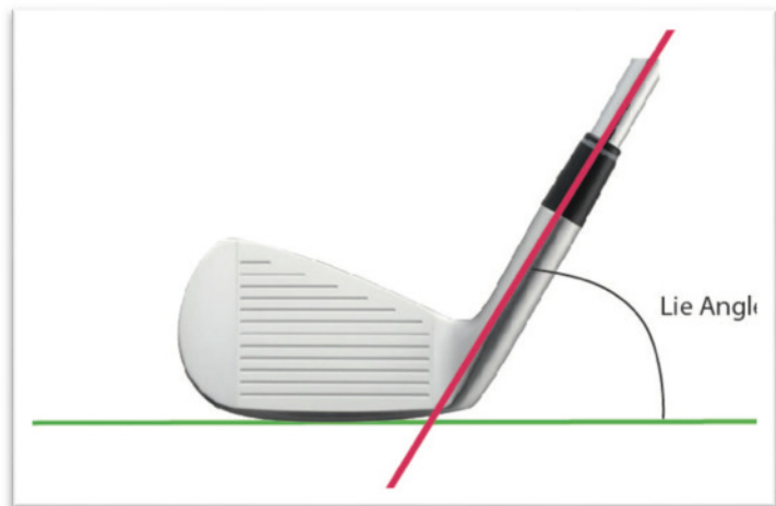
Abbildung 5: Der statische Lie wird zwischen Schaft und Boden gemessen.
